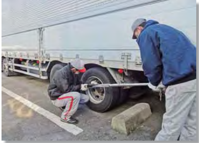
大型ディーラーの整備士による大型トラックへのトルクチェックの様子
