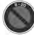
「道路標識、区画線及び道路標識に関する命令」に定める様式 細めの帯及び枠を赤色、文字及び線は白色、地を青色とする。
