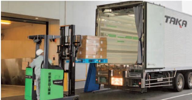
フィルムで巻いて固定してから、フォークリフトを使ってトラックに積み込み
