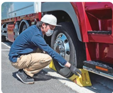
万トントラックが動くことのないよう、駐車したときにはタイヤの前後に止めを置きます
