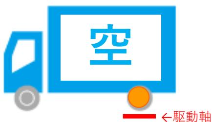
駆動軸に十分な荷重がかからず、発進性能が低下。
