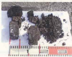
舗装内部の損傷状況
