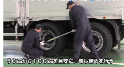
<トルクレンチを用いた増し締め>
