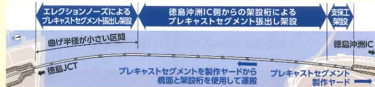
左：エレクションノーズによるプレキャストセグメント張出し架設
