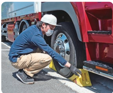
万トントラックが動くことのないよう、駐車したときにはタイヤの前後に止り止めを置きます
